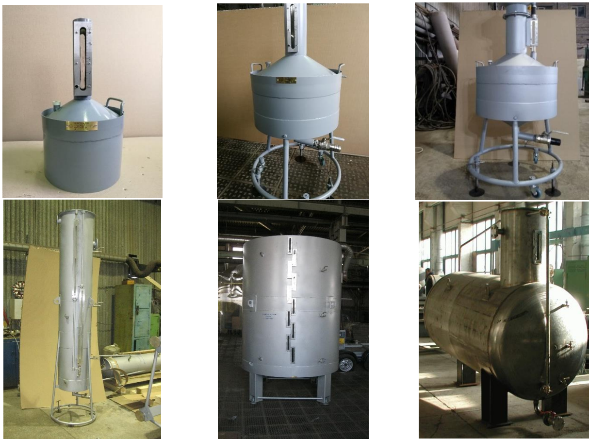
Рисунок 1 – Общий вид мерников металлических технических 1-го класса М1кл
