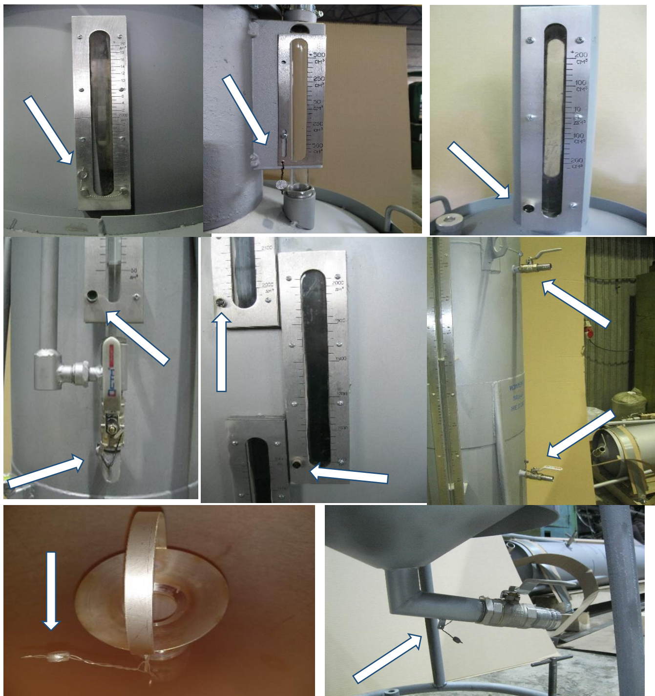
Рисунок 2 – Схема пломбировки от несанкционированного доступа, обозначение места нанесения знака поверки мерников металлических технических 1-го класса М1кл
